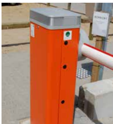
Som en option kan man få blinkende lys i bomhusets top, der advarer brugerne om, at bomanlæget er i bevægelse.
